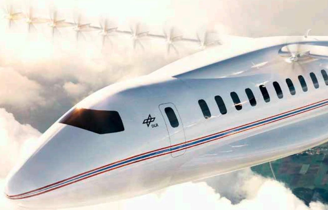
Viele kleine Propeller über die ganze Tragfläche verteilt, ein langer schmaler Flügel, ein kleines Seitenleitwerk: So könnte das elektrische Regionalflugzeug der Zukunft aussehen.
