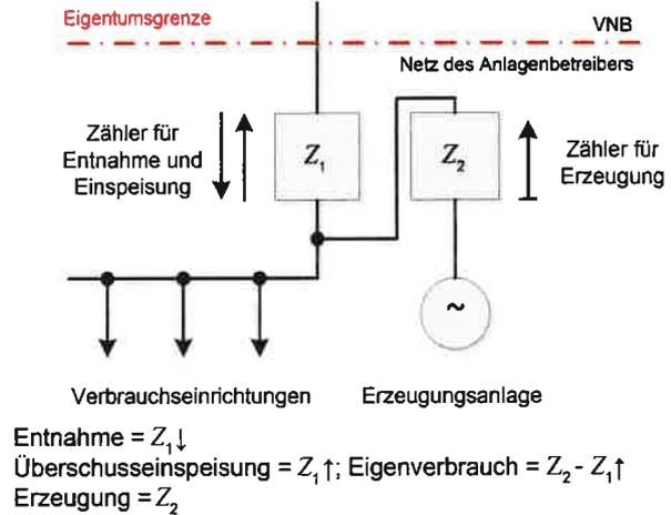
**Messkonzept 4 - KWK-Untermessung (§ 6 Abs. 3 KWKG 2015, geändert 2017)**
